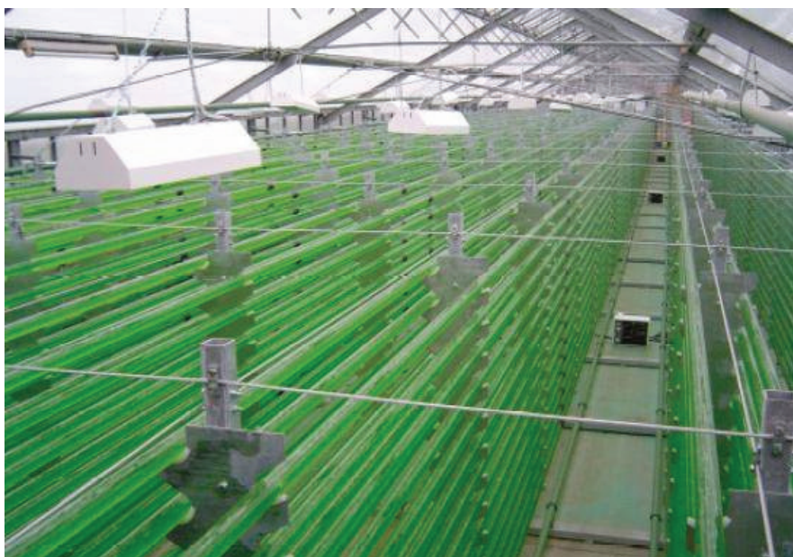
Рис. 8.5. Трубчатый биореактор в закрытых помещениях
