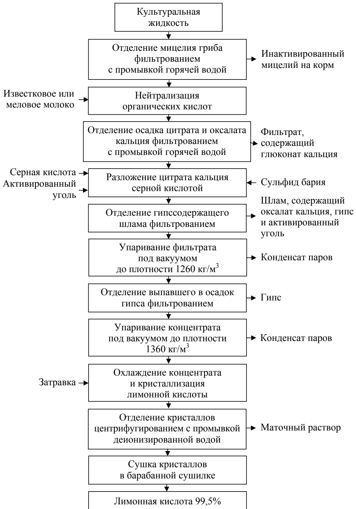
Рис. 14.2. Схема выделения лимонной кислоты из культуральной жидкости
