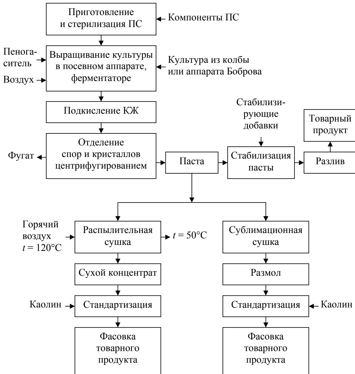
Рис. 11.1. Общая схема получения бактериальных энтомопатогенных препаратов
