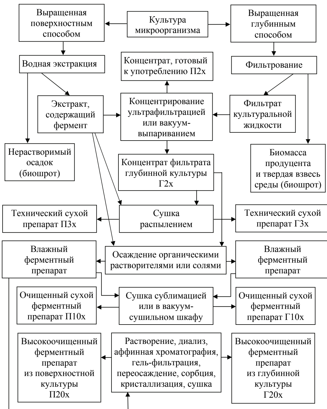
Рис. 9.1. Принципиальная схема получения технических и очищенных ферментных препаратов из культур микроорганизмов
